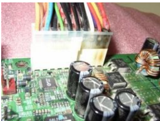
Der Stromanschluss des Netzteils ist mit dem Motherboard verschmolzen, die Kabel sind durch die Hitze zum Teil angeschmort
