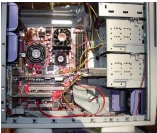
Die Hardware: ein Dual-Prozessor-System mit reichlich Arbeitsspeicher
